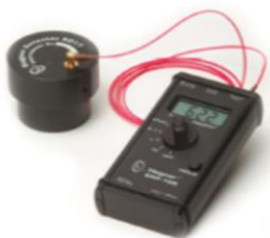
Medidor de luminiscencia portátil para inspecciones in situ
